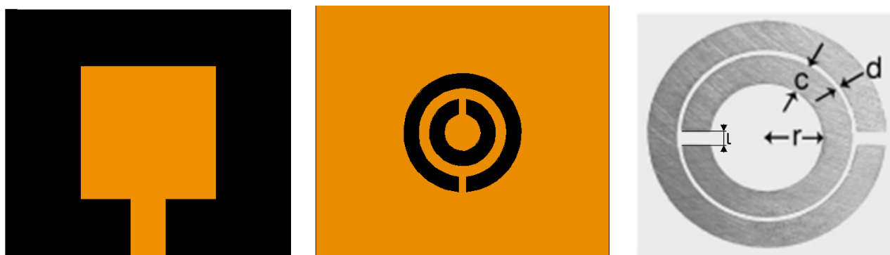
Рис. 1. Модель микрополосковой антенны с неоднородной подложкой
