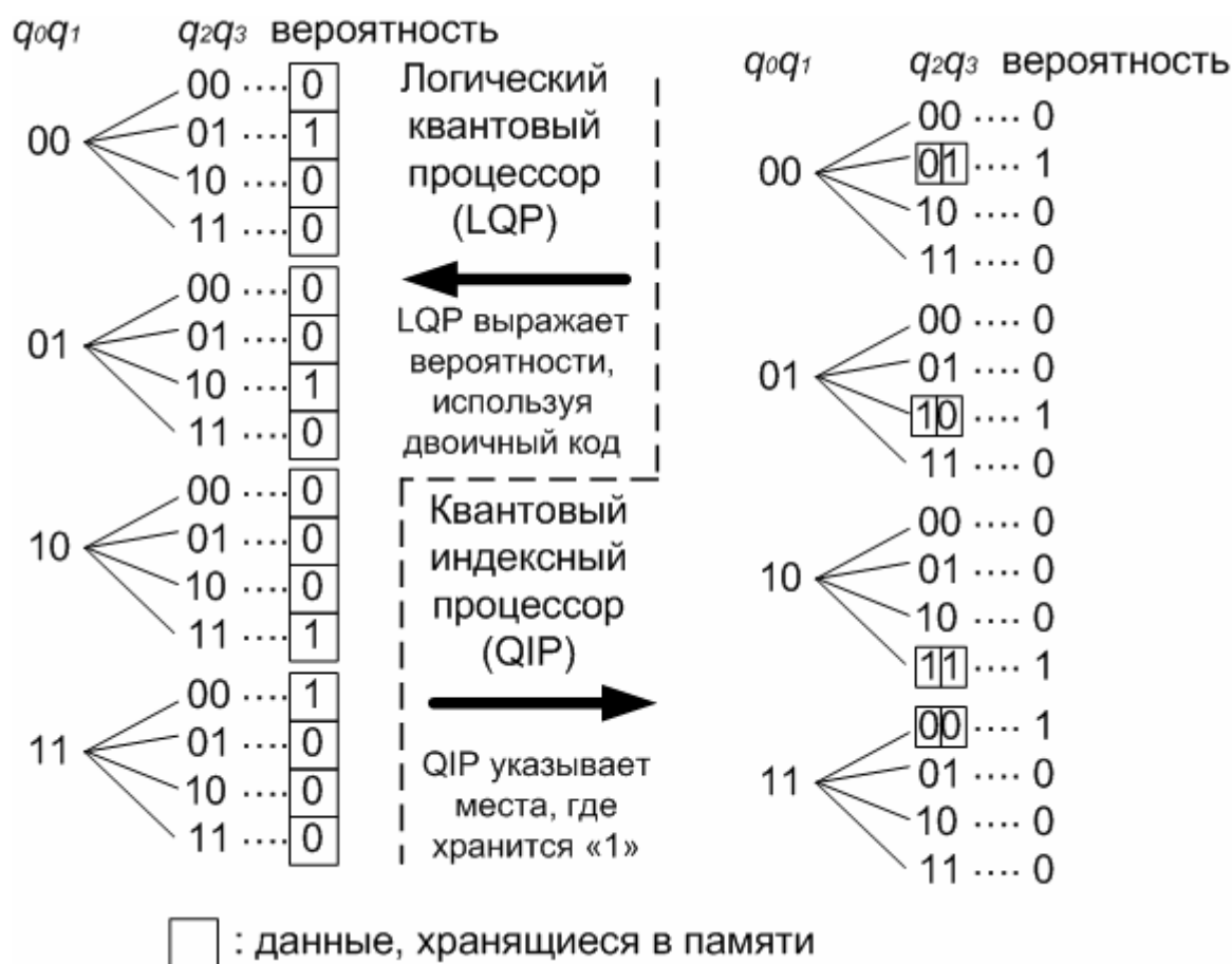
Рис. 1. Сравнение квантовых состояний LQP и QIP
